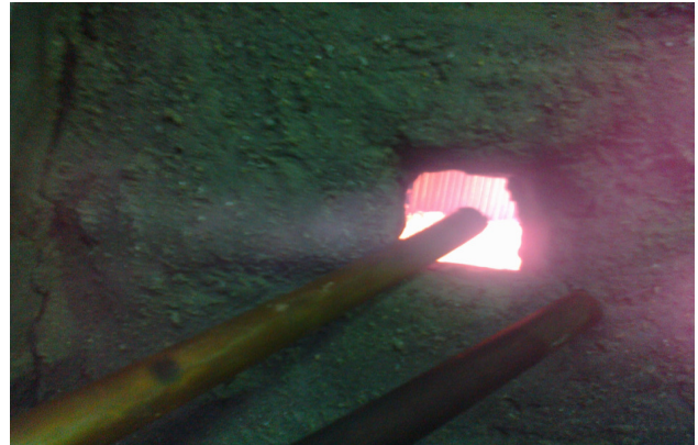
شکل ۴- نمایی از پختن لوله نانو در کوره
